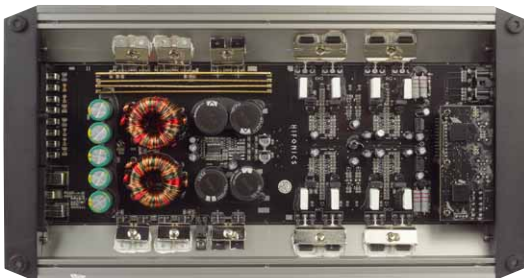
Auch die IV/800 (links) hat ein Doppelnetzteil, die Monos sind ähnlich aufgebaut, die größere I/2000 bietet mehr Netzteil und mehr Transistoren
