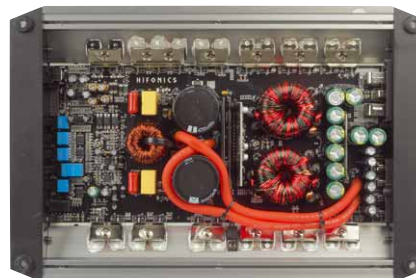
Auch die IV/800 (links) hat ein Doppelnetzteil, die Monos sind ähnlich aufgebaut, die größere I/2000 bietet mehr Netzteil und mehr Transistoren
