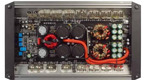
Auch die IV/800 (links) hat ein Doppelnetzteil, die Monos sind ähnlich aufgebaut, die größere I/2000 bietet mehr Netzteil und mehr Transistoren
