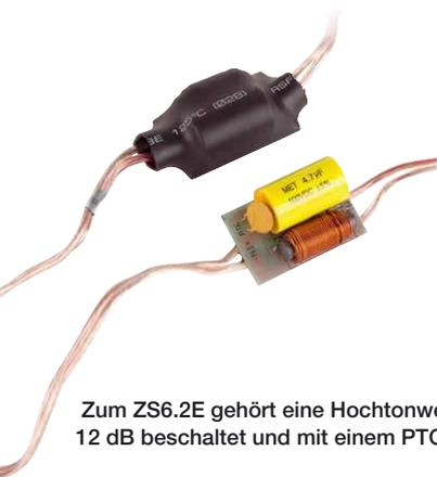
Zum ZS6.2E gehört eine Hochtonweiche, die den Tweeter mit 12 dB beschaltet und mit einem PTC-Element schützt
