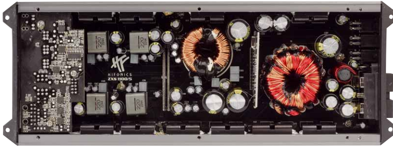
Die ZXS1100/5 fällt deutlich schlanker aus als die ZXR. Links die gekapselten Spulen der kleinen Kanäle, in der Mitte die große Spule für den Basskanal
