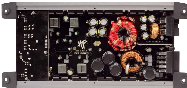
Die ZXR1200/5 ist großzügig mit Netzteil und Pufferung ausgestattet
